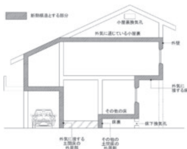
図資 7-1-1 断熱構造とする部分
