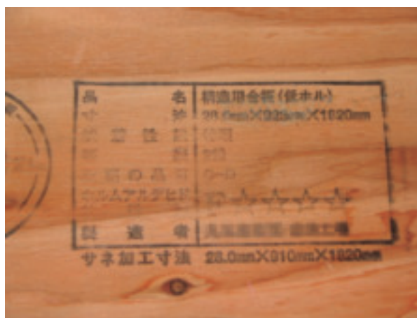
図5-1-1 ホルムアルデヒド発散量の表示(JAS、構造用合板)
