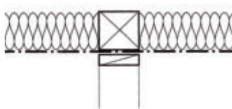
(a) 外壁の防湿気密フィルムを先行する場合
